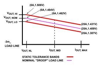
FIGURE 11. LOAD LINE EXAMPLE
