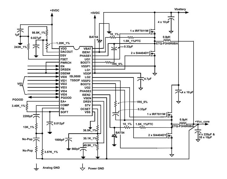
FIGURE 14. TYPICAL APPLICATION CIRCUIT FOR CORE VOLTAGE REGULATOR
