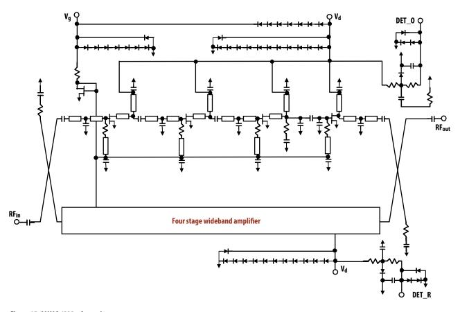
Figure 15. AMMC-6333 schematic
