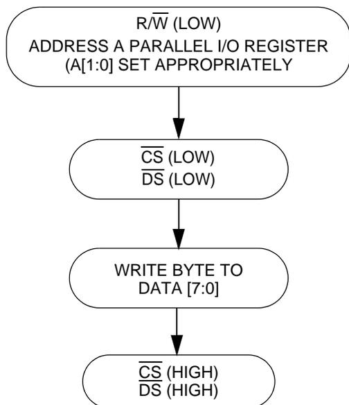
**Figure 26. Motorola Mode, One-Byte Write Flow Diagram**
