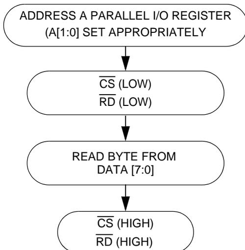
**Figure 25. Intel Mode, One-Byte Read Flow Dia-**
