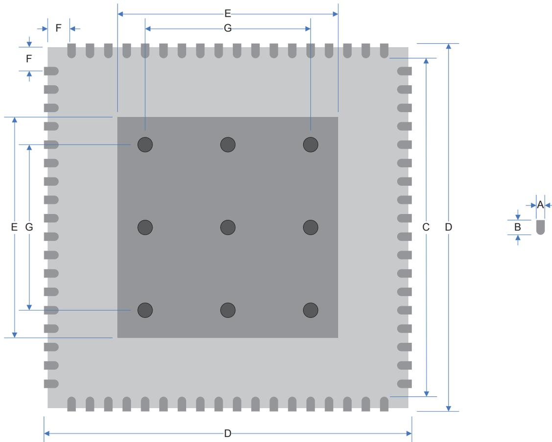
**Figure 4 72 Lead QFN Land Pattern (QFN package QH072AF2A)**
