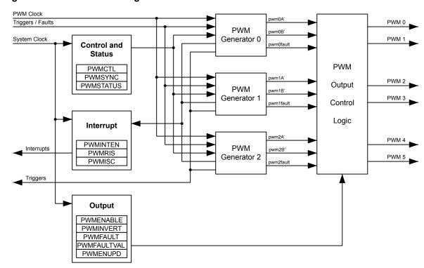
Figure 20-1. PWM Module Diagram
